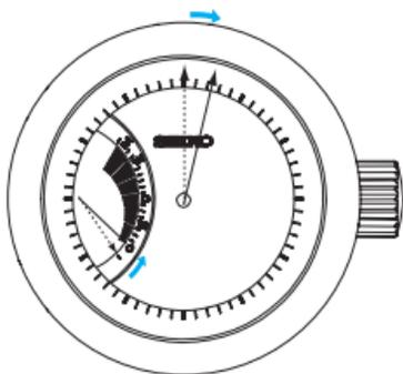
2. Après avoir continué la production de courant électrique par rotation de la couronne pendant un certain temps, l'aiguille de l'indicateur de commande directe se déplace à la graduation 0 et la trotteuse commence à se déplacer. Arrêtez de tourner la couronne et vérifiez le déplacement.
